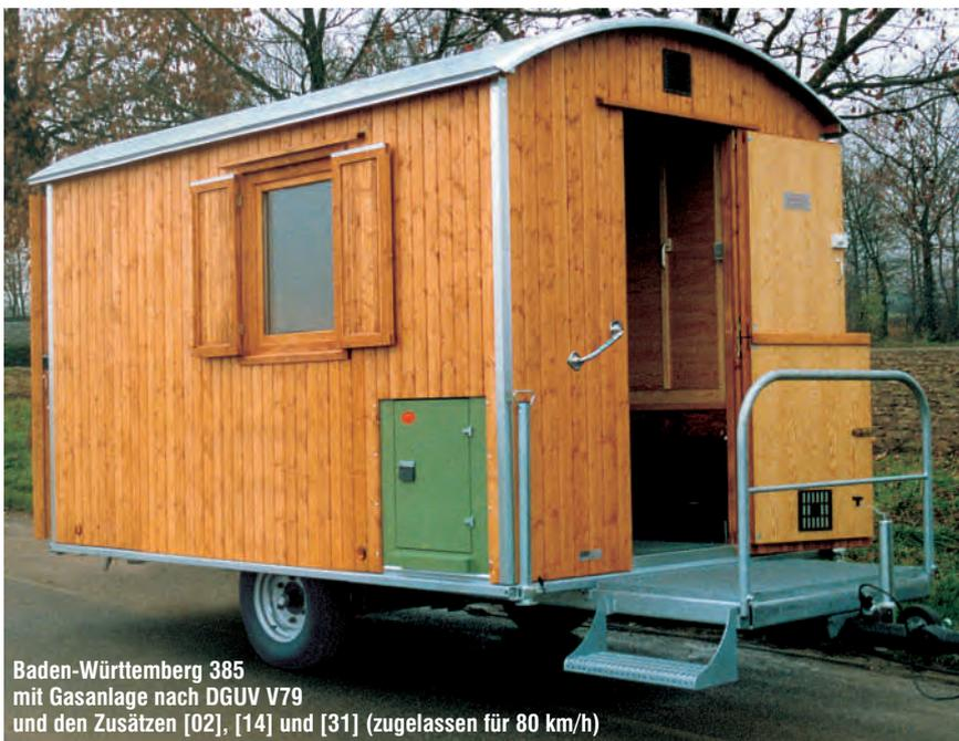
Baden-Württemberg 385 mit Gasanlage nach DGUV V79 und den Zusätzen [02], [14] und [31] (zugelassen für 80 km/h)
