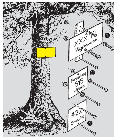
• **Befestigung mit Eichenholzleiste**, 25x4cm, abgèschrägt, 4x gelocht, 2 verzinkte Schrauben / Muttern, 2 Aluminium-Nägél 4,5x80mm. Das Format der Holzleiste erlaubt die Anbringung von Schildern mit einem Lochabstand von 12cm (Schilder mit einer Höhe bis 15cm). Größere Schilder auf Anfrage.
