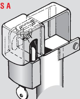
Das normale Vorhängeschloß wird durch eine Stahlkappe gegen Gewalt und Witterung geschützt. Der gefährdete Schloßbügel kann nur sehr schwer durchtrennt werden.
