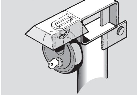
Bei Diskusschlössern mit sehr kleinem Bügel sorgt ein Stahldach für einen zusätzlichen Schutz gegen Gewalt und Witterung von oben. An diesen Verschuß passen alle sonstigen Schlösser.
