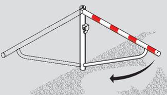
Arretierung am Drehpunktpfosten, dieser verstärkt:
