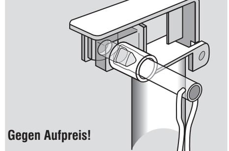
MARTENS Patent-Verschuß ohne zusätzliches Schloß. Ein verdeckter Messingbolzen mit einem 3- oder 6-Kant-Kopf wird mit einem Spezialschlüssel zum Öffnen und Schließen gedreht. Der Dreikant passt zum deutschen Feuerwehr-Hydranten-Schlüssel nach DIN 3223 (Schenkelweite 18mm).
