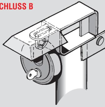
Bei Diskusschlössern mit sehr kleinem Bügel sorgt ein Stahldach für einen zusätzlichen Schutz gegen Gewalt und Witterung von oben. An diesen Verschluss passen alle sonstigen Schlösser.
