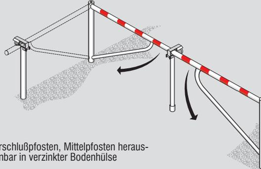
3 Verschlusspfosten, Mittelpfosten herausnehmbar in verzinkter Bodenhülse
