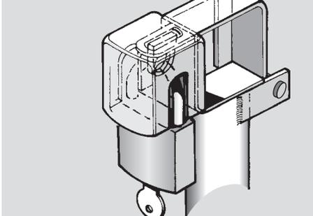
Das normale Vorhängeschloß wird durch eine Stahlkappe gegen Gewalt und Witterung geschützt. Der gefährdete Schloßbügel kann nur sehr schwer durchtrennt werden.
